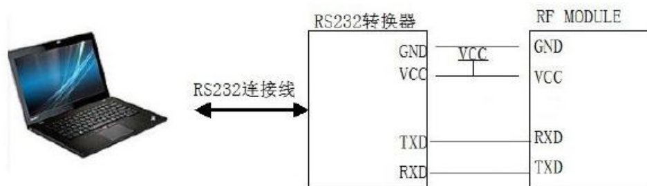
图三 无线模块和电脑连接示意图（TTL）
