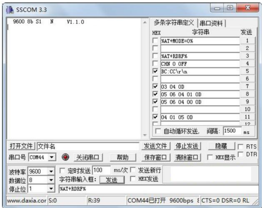
图四 用串口调试助手获取模块当前串口参数
